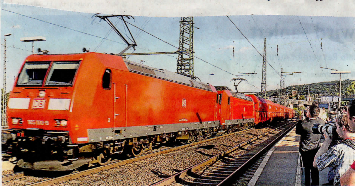
Der Testzug in Bingen bewies, wie leise Flüsterbremsen im Vergleich zur herkömmlichen Grauguss-Sohle sind. Dabei sind K- und LL-Sohlen gleich effektiv, aber LL ist billiger.
